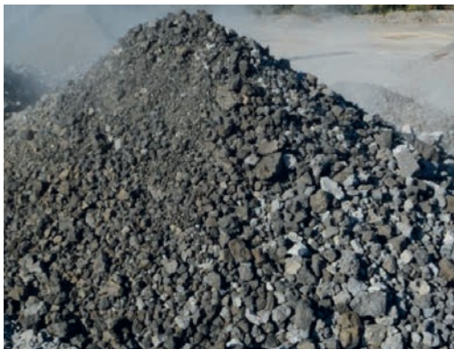
Partie supérieure des terrassements (PST) : 42 500 tonnes de laitier de haut-fourneau de granulométrie 0/100 mm
