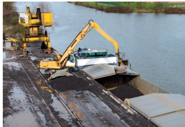
Acheminement des laitiers par voie fluviale
